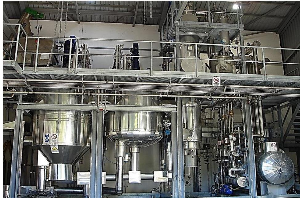
A partir de 1000 kg de déchets plastiques, on gagne environ 850 litres de fioul de qualité, qui est utilisable, en plus de l'application huile de chauffage ou carburant, comme matériau de base dans l'industrie chimique. Pendant le processus, environ 10% de gaz combustibles sont produits et sont valorisés pour chauffer l'installation.
